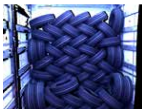
3D-punktmoln med färgtextur som visar en stapel svarta däck, skannad från ett avstånd på 4 meter (13,1 fot).
