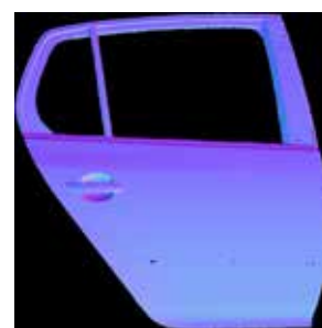
3D-skanning med normalkartor av en repad och skadad bildörr från 3,5 meters (11,5 fot) avstånd.
