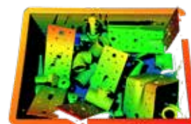
Punktmoln färgat med djupkarta som visar en ostrukturera låda med reflekterande metalleder.
