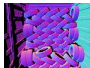
3D-punktmoln med normalkartor som visar en stapel svarta däck, skannad från ett avstånd på 4 meter (13,1 fot).
